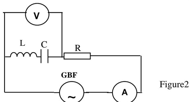
1) En faisant varier la fréquence  $N$ , le voltmètre(V) indique une tension nulle pour une valeur  $N_0$  de  $N$  ; l'ampèremètre(A) indique alors une intensité efficace  $I_0=0,2A$ .
